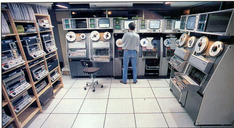
Les magnétoscopes image par image VP R3 Ampex en œuvre chez Mikros Image.
